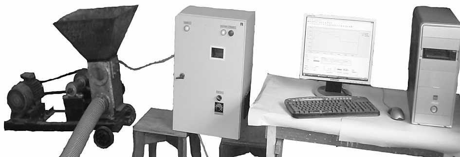
Рис.10. Загальний вигляд експериментальної установки та обладнання для регулювання частоти обертання ротора електродвигуна і отримання результатів
