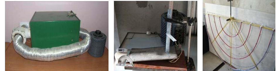
Рис. 8. Лабораторні установки для моделювання окремих операцій процесу гранулювання методом кочення
