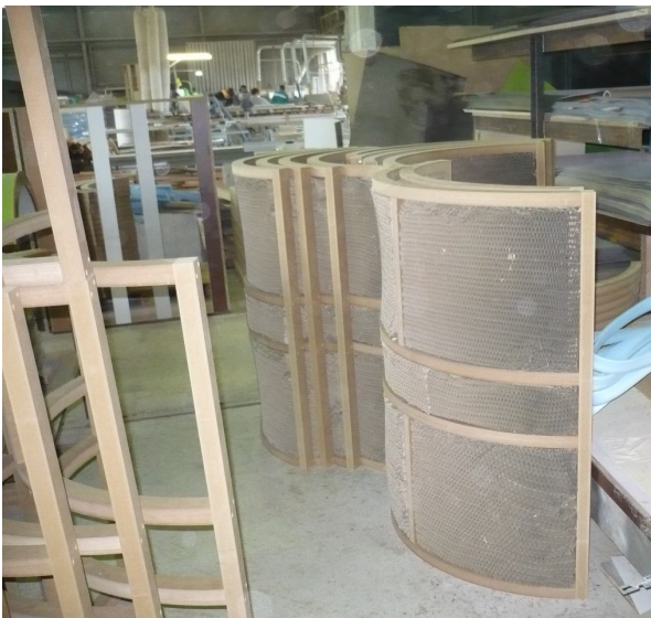
Рисунок 6 – Заготовка криволінійної деталі з тамбурату
