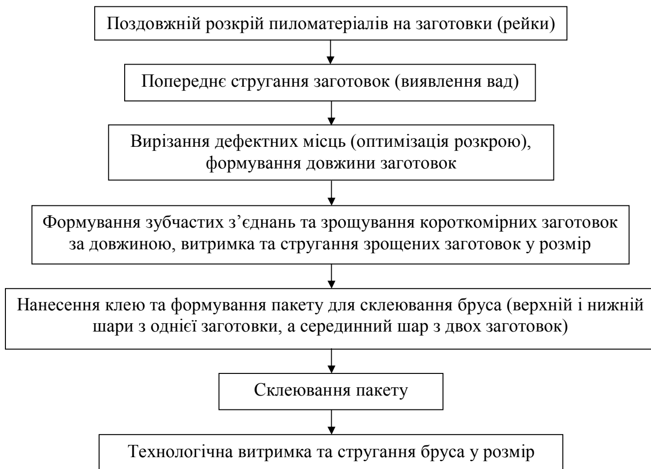
Рисунок 3 – Схема технологічного процесу виготовлення клеєного тришарового порожнистого бруса з сухих пиломатеріалів.
