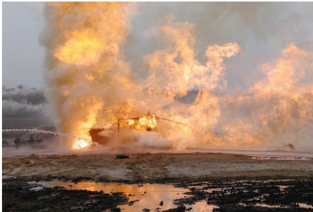
Рис. 1 . Відкритий фонтан на експлуатаційній свердловині
