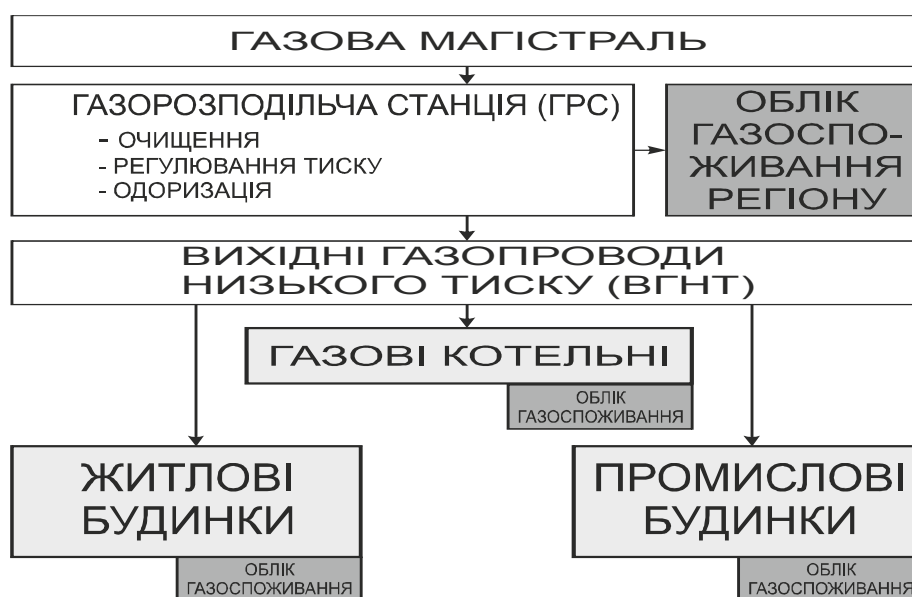
Рисунок 1. Загальна схема газоспоживання міста
