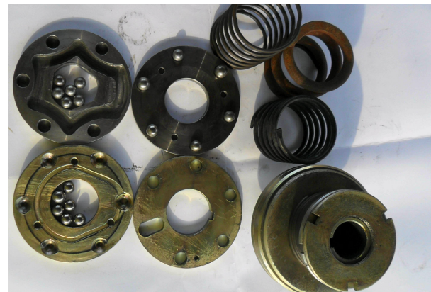
Рисунок 3. Кулькові низькочастотні запобіжні муфти: а) конструкція; б) загальний вигляд
