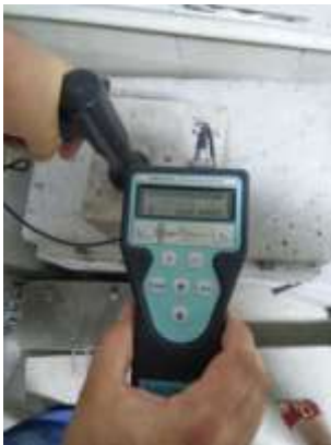
Рисунок 1 – Дослідження бетонних кубів методом ударного імпульсу приладом прилад ИПС-МГ4.03
