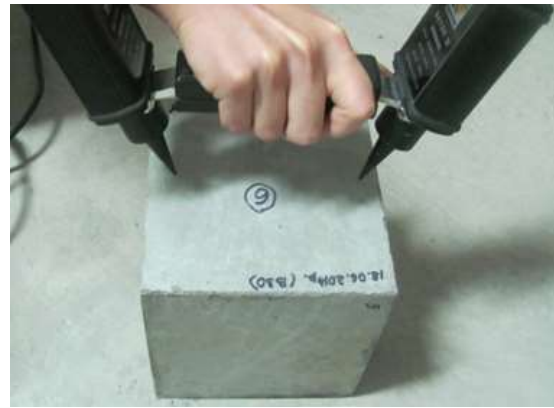
Рисунок 2 – Дослідження бетонних кубів ультразвуковим методом приладом «Бетон-32»
