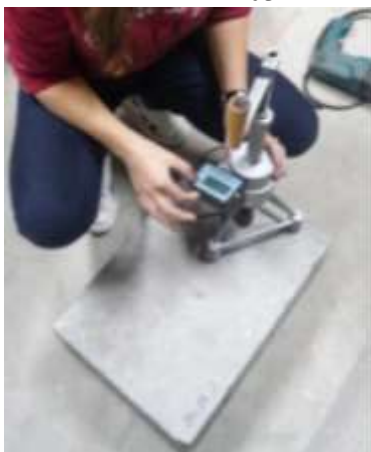
Рисунок 3 – Дослідження залізобетонної плити методом відриву зі сколюванням приладом ПОС-50МГ 4.0
