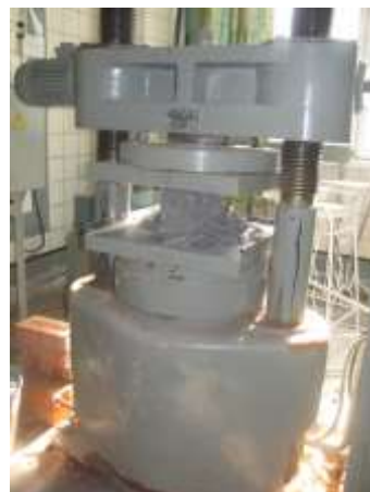
Рисунок 4 – Дослідження бетонних кубів на гідравлічному пресі П-125
