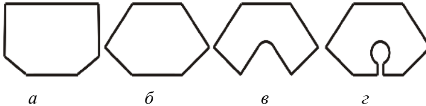
Рисунок 10 – Конструкція вузлових косинок
