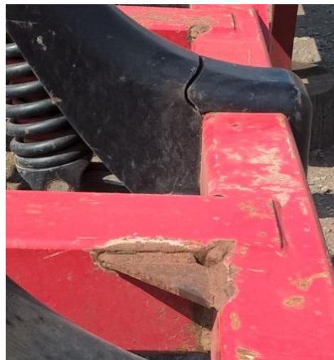
Рис. 2. Дефектність типу тріщин несучої системи культиватора Tiger 8 LT фірми Horsch
