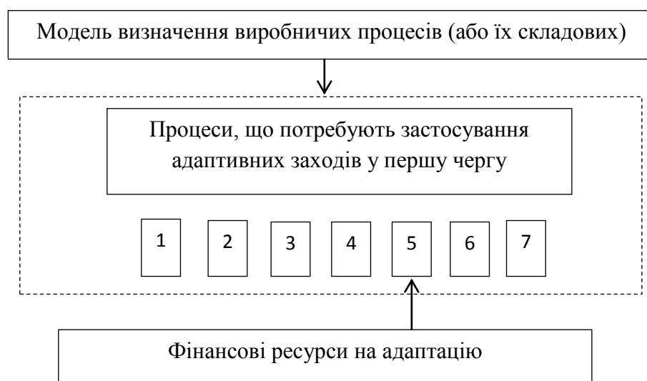
Рис. 5.3. Узагальнена схема результатів застосування моделі вибору послідовності реалізації адаптивних заходів
