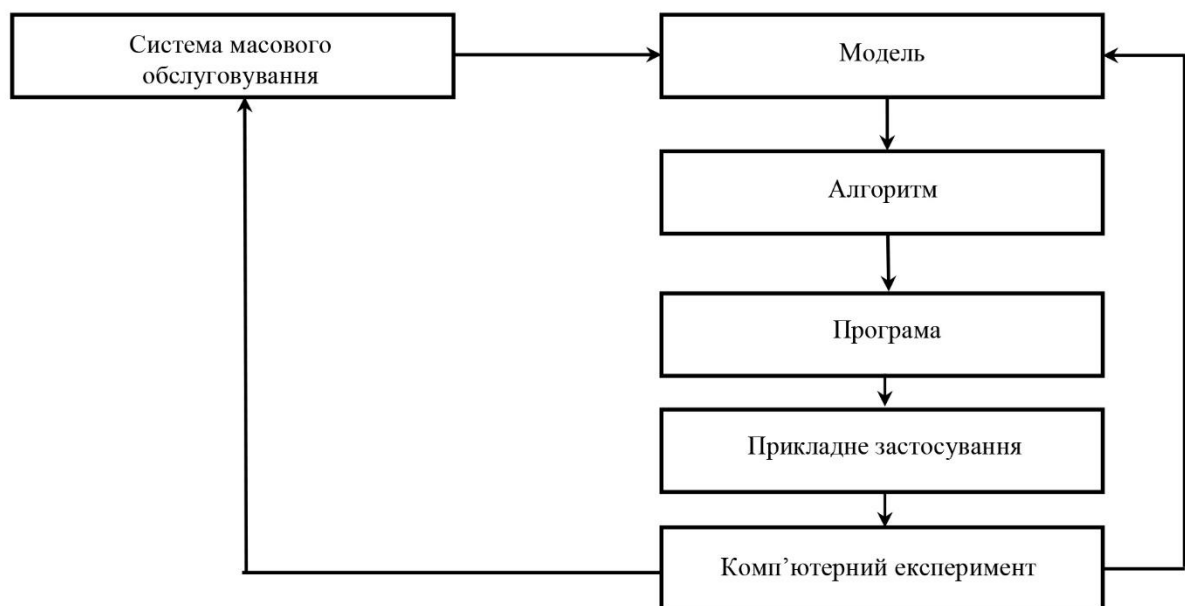
Рисунок 2.1 – Схема інформаційної технології для аналізу СПП та процесів
