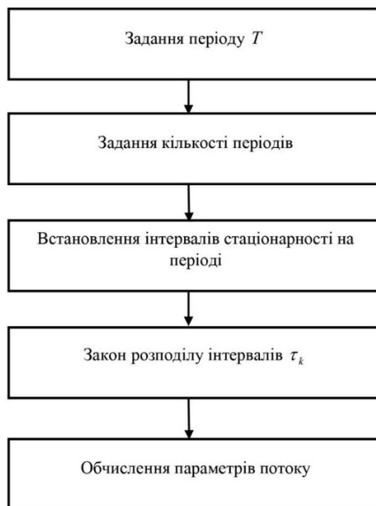
Рисунок 5.5 – Схема імітаційного моделювання періодичних пуассонівського і рекурентного кусково стаціонарних потоків
