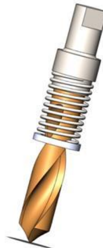
Рис. 6. Сверло сборное для сверления ЛДСтП
