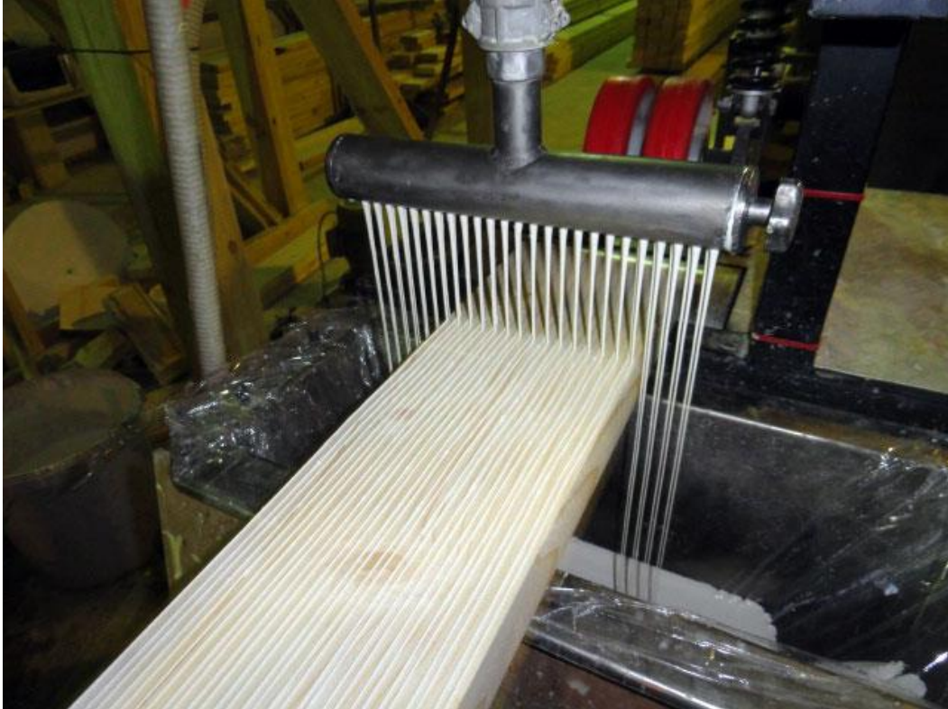
Рисунок 2 - Процесс нанесения клея в виде нитей.
