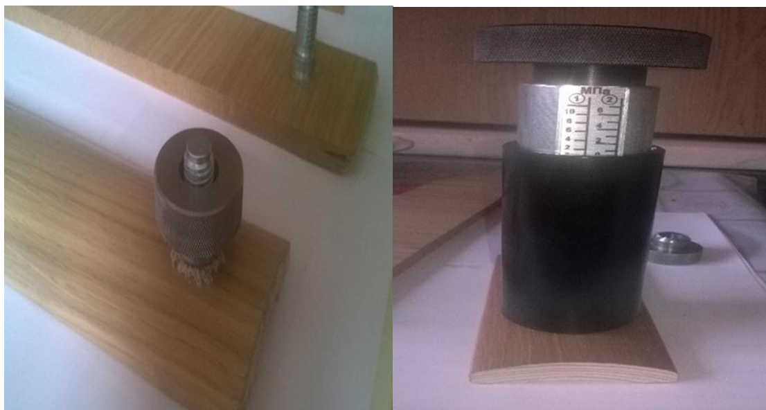
Рисунок 1- Визначення адгезії адгезиметром Константа АЦ
