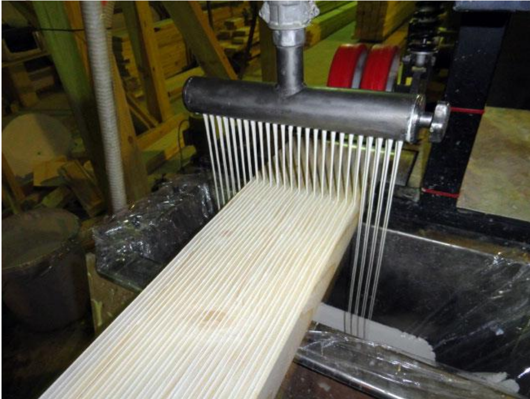
Рисунок 2 - Процесс нанесения клея в виде нитей.
