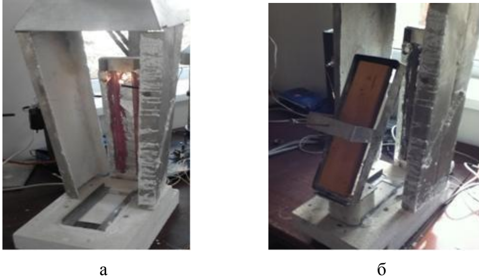
Рис.1. Пристрій для визначення індексу поширення полум'я (а) зі встановленим для випробування зразком (б)
