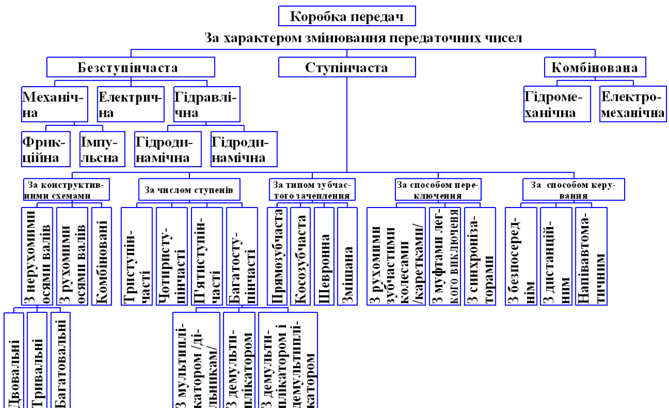
Рисунок 8.2 – Класифікація коробок передач
