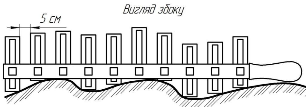
Рисунок 10.5. Вимірювання гребенястості поверхні ріллі за допомогою профілеміра
