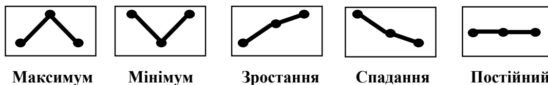
Рис. 2. Класи патернів запропонованої переставної ентропії при m = 3 .
