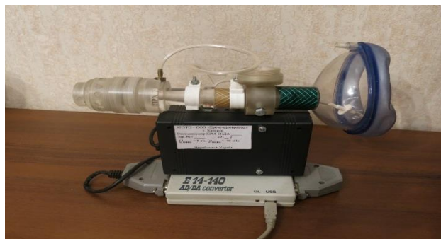
Рисунок 1 – Загальний вигляд пристрою для оцінки респіраторно-нюхової функції людини
