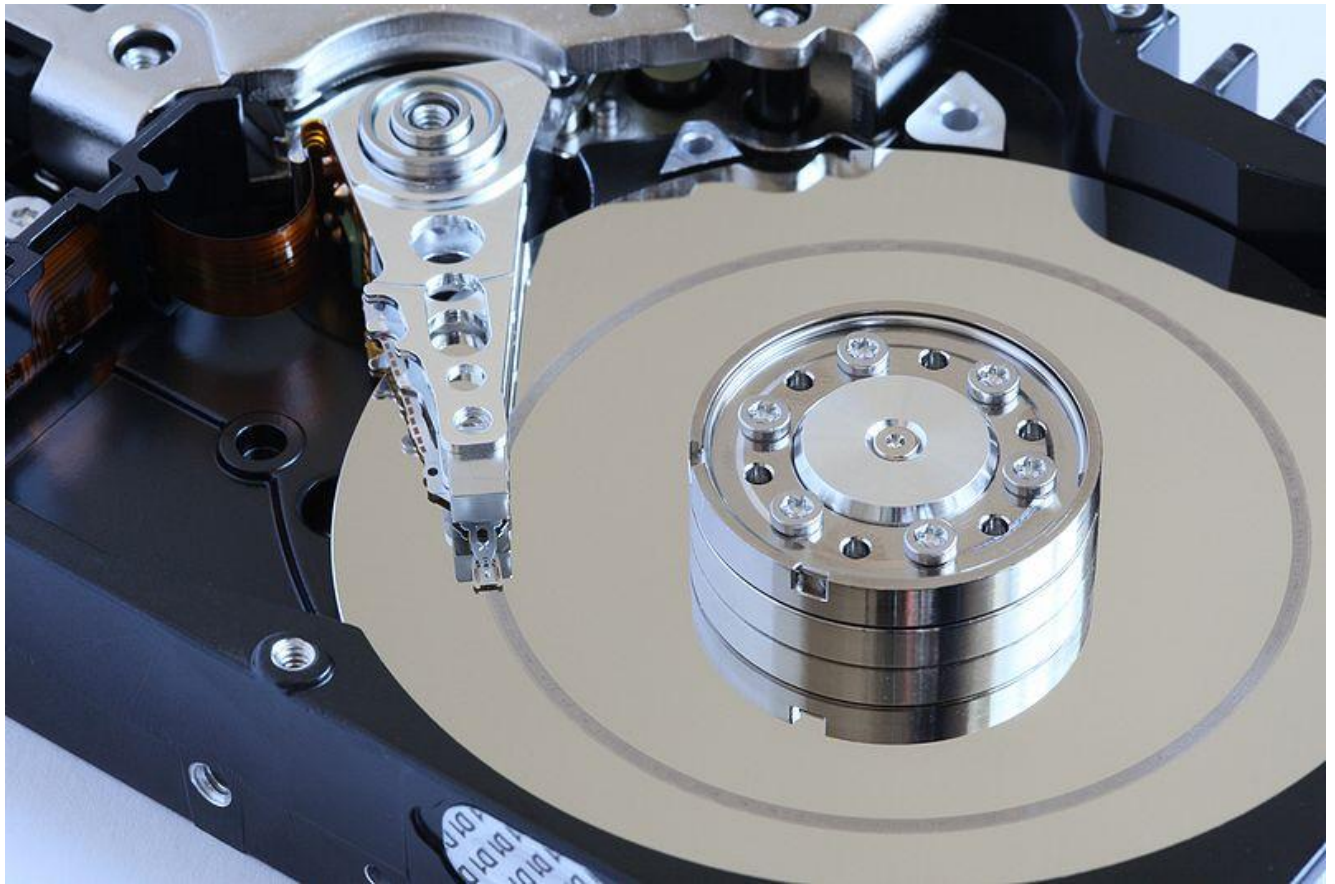
Рис. 12 Наслідки дотикання магнітної головки до поверхні диска
