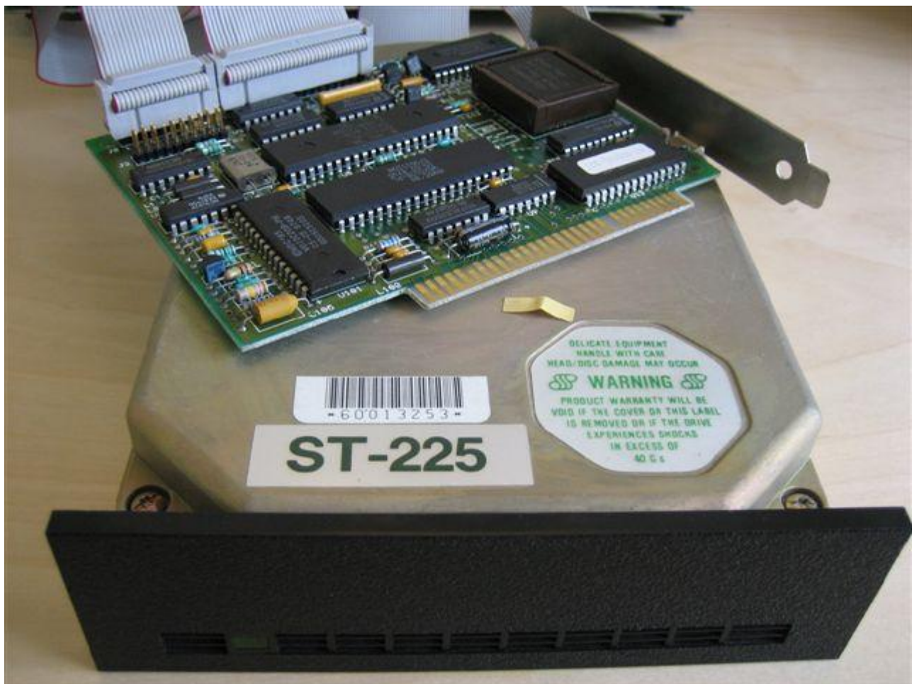
Рис. 13 Для підключення до материнської плати потрібен контролер
