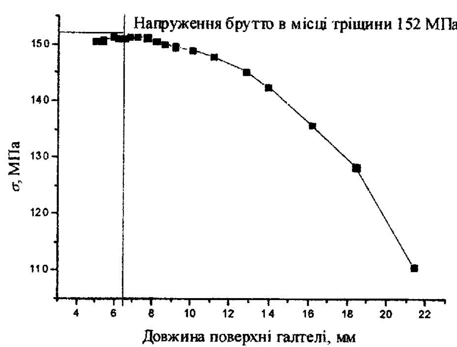
Рис. 6. Залежність нормальних напружень на поверхні галтелей від віддалі вздовж її поверхні при силі 260 кН на боксу колеса
