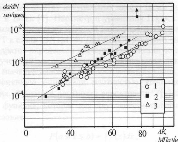
Рис. 1. Залежність швидкості РУТ в сталі 25Х1М1Ф при температурах  $+20^\circ\text{C}$  (1),  $+375^\circ\text{C}$  (2)  $+600^\circ\text{C}$  (3) от размаху КИН
