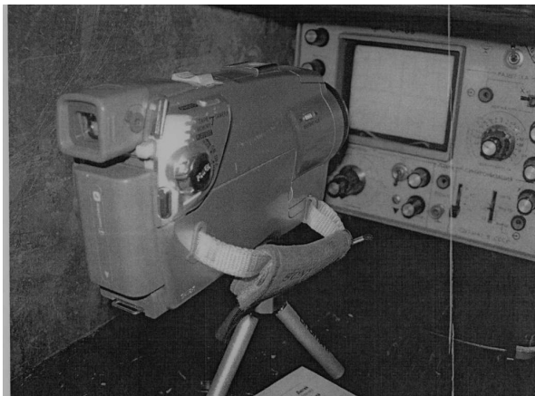
Рис.2. Запис процесу знімання діаграми ударно-втомного руйнування відеокамерою з екрану осцилографа в процесі консольного деформування зразка-балки
