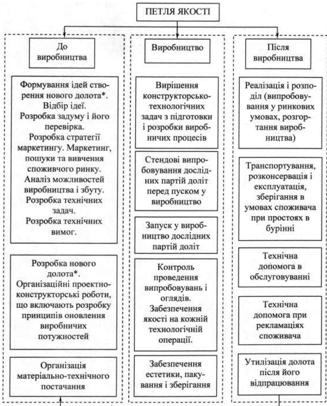
Рисунок 5.1 – Схематична модель петлі якості долота відповідно до міжнародних стандартів ISO 9000 (нове долото* – долото модернізоване чи нової конструкції, типорозміру, або виготовлене за новою технологією, з підвищеними вимогами по точності, якості тощо) [6]
