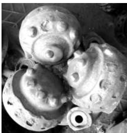
Рисунок 1.7 – Характер руйнування вставного породоруйнівного оснащення тришарошкового долота, що працювало на вибій з наявним твердим сплавом
