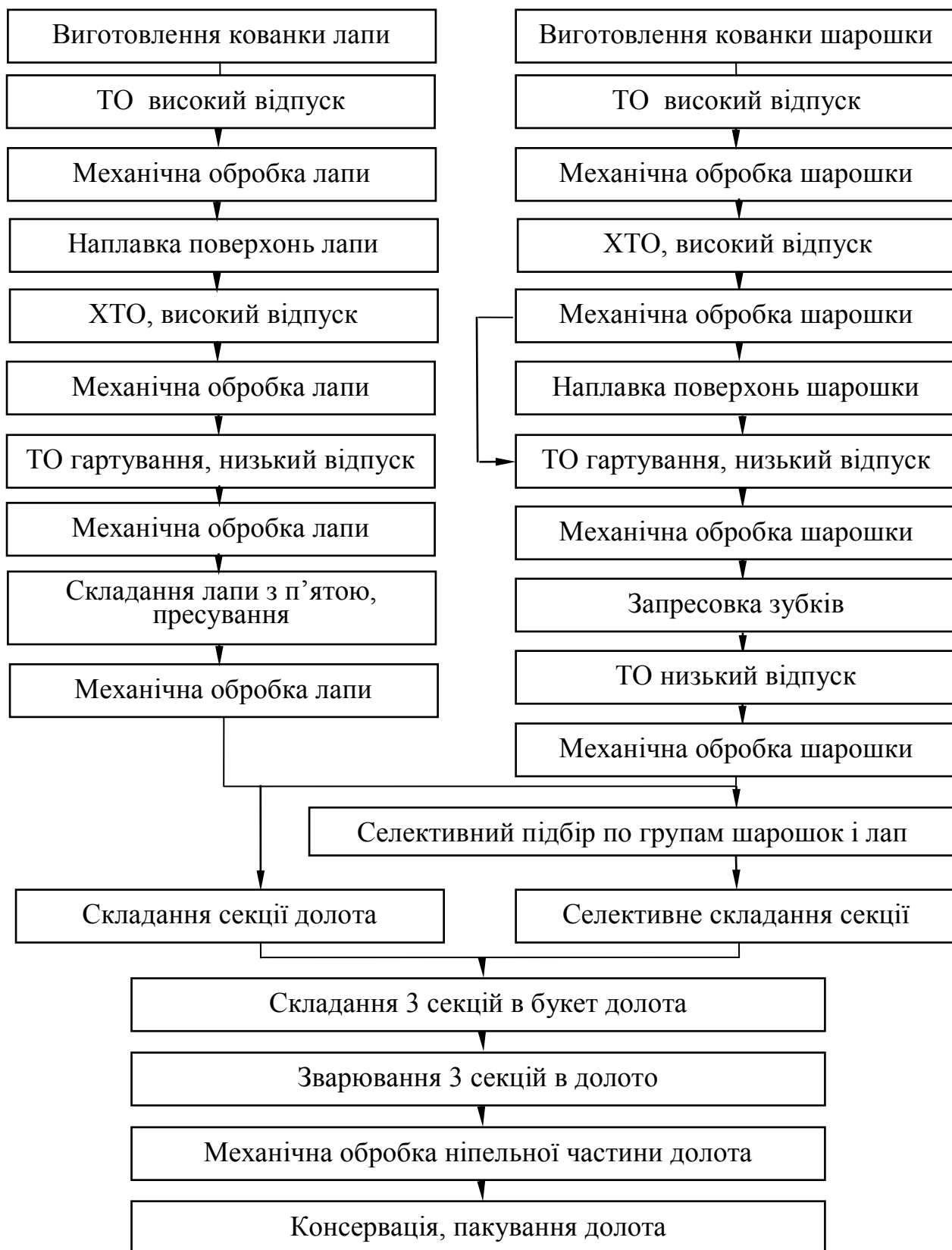
Рисунок 1.9 – Схема типового технологічного процесу виготовлення тришарошкового бурового долота
