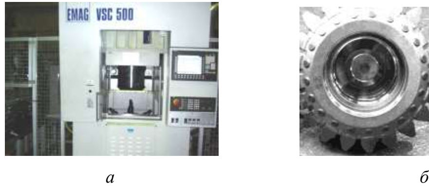
Рисунок 3.14 – Загальний вигляд токарного центру VSC-500 фірми „EMAG”, налагодженого для оброблення елементів опори шарошок бурових доліт (а) та загальний вигляд оброблених поверхонь шарошки бурового долота типорозміру \varnothing 444,5 мм (б) [12]
