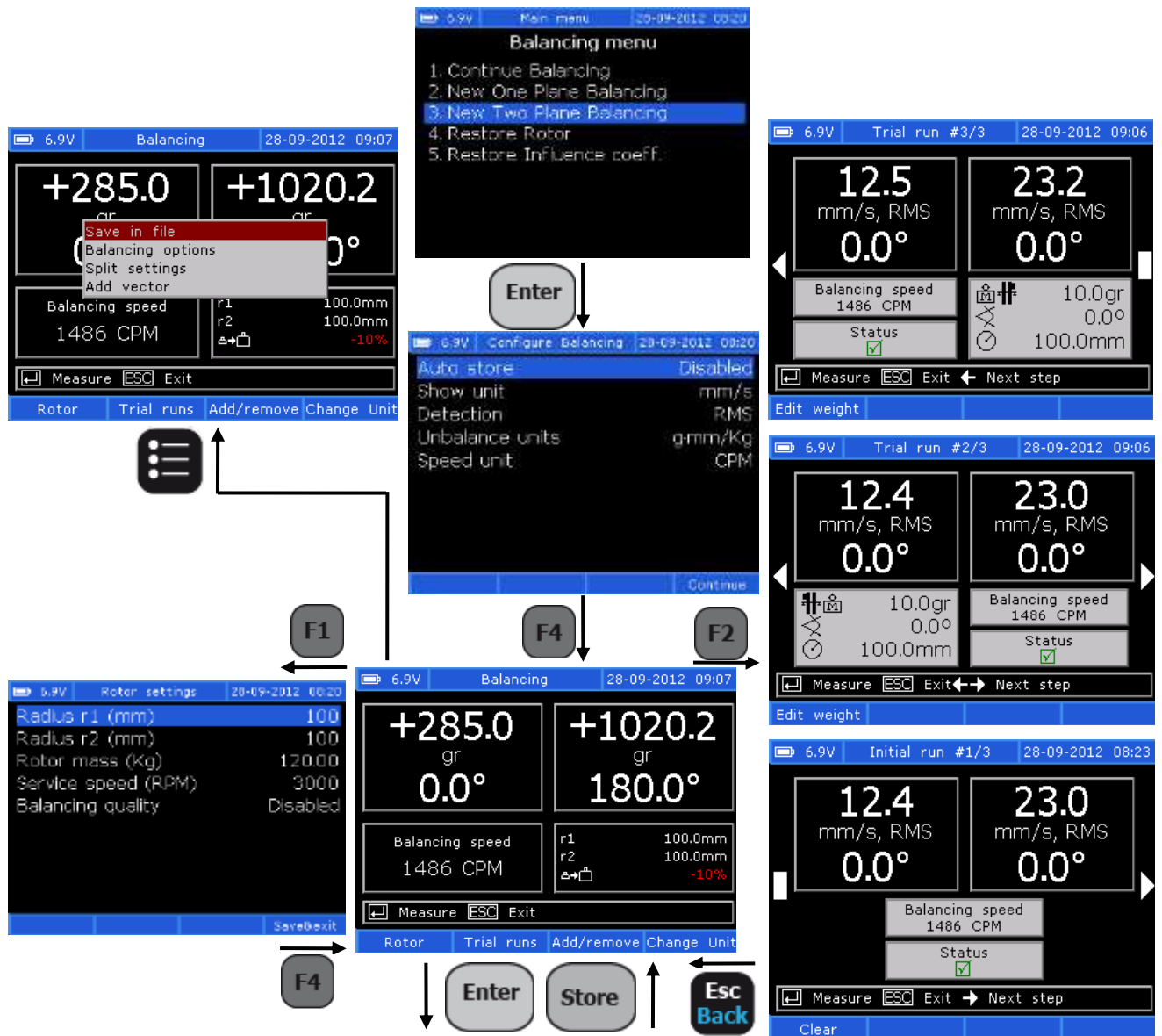
Рисунок 3.10 – Схема послідовності кроків балансування
