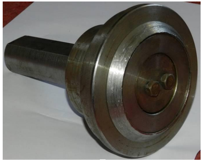
Рис. 16. Конструктивна схема (а) та загальний вигляд (б) формувального інструменту для виготовлення вигнутого профілю на ГЗ
