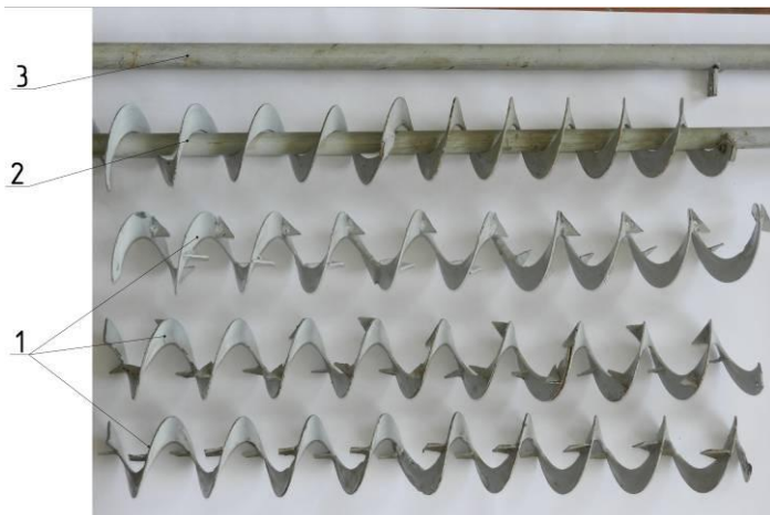
Рис. 12. Шнекові оправи: 1 – ГЗ підвищеної жорсткості, 2 – шнекова оправа із закріпленою ГЗ підвищеної жорсткості, 3 – вал
