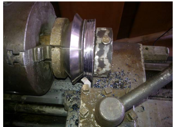
Рис. 18. Загальний вигляд процесу проточування зовнішнього крайки ГЗ
