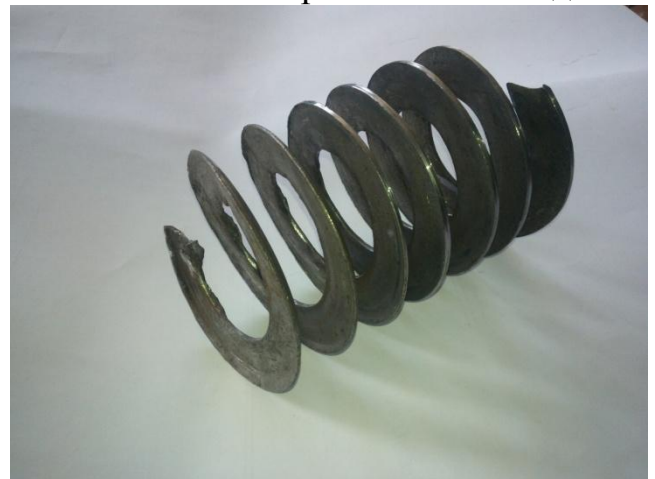
Рис. 21. ГЗВП після процесу проточування зовнішньої крайки
