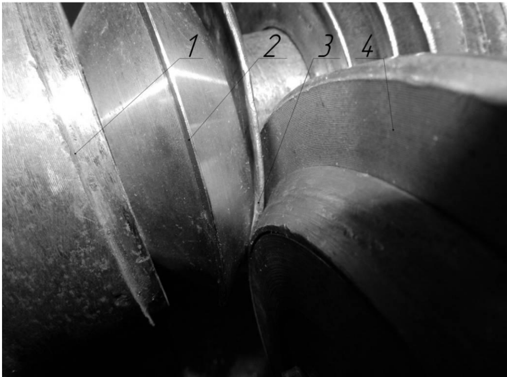
Рисунок 3.4. – Початковий етап формоутворення вигнутого профілю ГЗ з допомогою формувального ролика: 1 – оправа, 2 – формувальна втулка, 3 – вигнутий профіль ГЗ, 4 – формувальний інструмент
