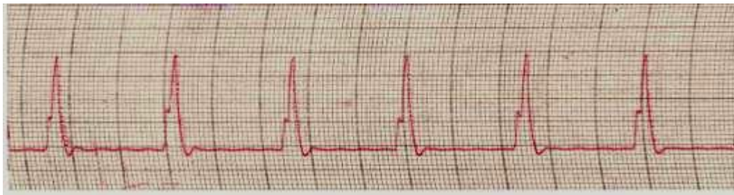
Рисунок 1.9. - Осцилограма процесу проточування зовнішньої крайки ГЗ ( t = 1,0 мм; S = 0,4 м/хв.; V = 150 м/хв.; Pz = 400 Н)
