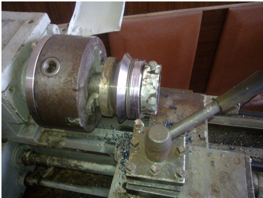
Рисунок 3.9. – Загальний вигляд процесу проточування зовнішньої крайки вигнутого профілю ГЗ
