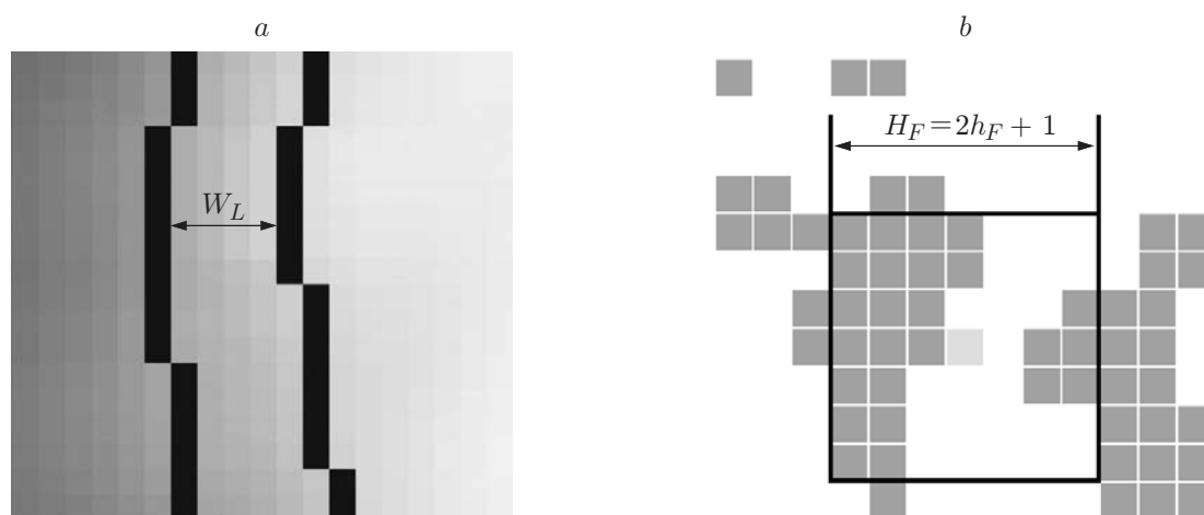
Рис. 3. Влияние главных параметров алгоритма на результат оценки положения трещин: a — смещение края объекта на расстояние W_L , вызванное изменением фонового порога; b — процесс объединения отделённых фрагментов трещины под воздействием размера ядра фильтра
