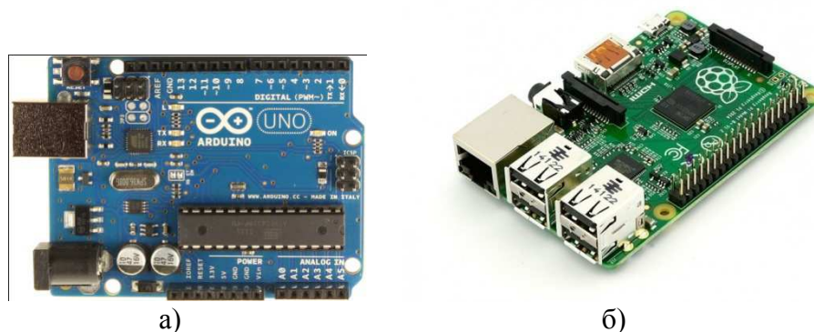
Рис.1. Загальний вигляд мікроконтролерів Arduino а) та Raspberry Pi б)
