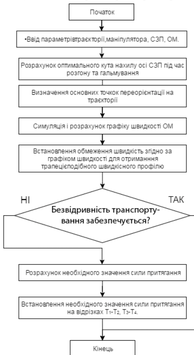
Рис. 2. Алгоритм забезпечення орієнтації струминного захоплювального пристрою
