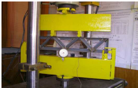
Рисунок 2 – Дослідження фізичної моделі зварної ферми
