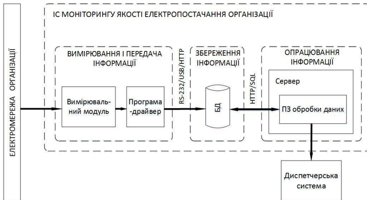
Рис. 1. Структурна схема пропонованої ІТ моніторингу якості електропостачання
