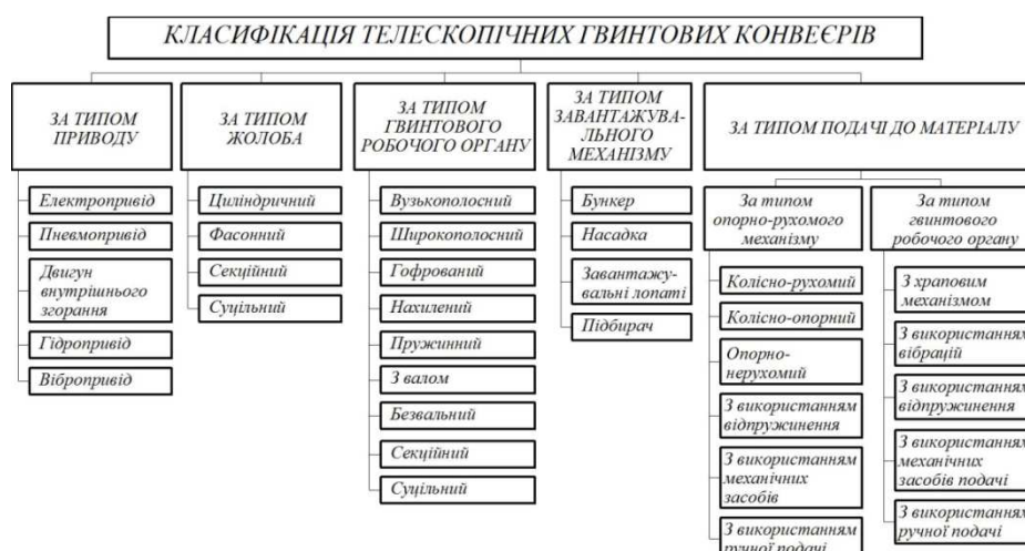
Рисунок 1 - Класифікація телескопічних гвинтових конвеєрів за конструктивними ознаками
