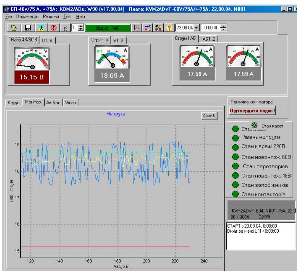
Рисунок 3 – Інтерфейс програми моніторингу джерела гарантованого живлення
