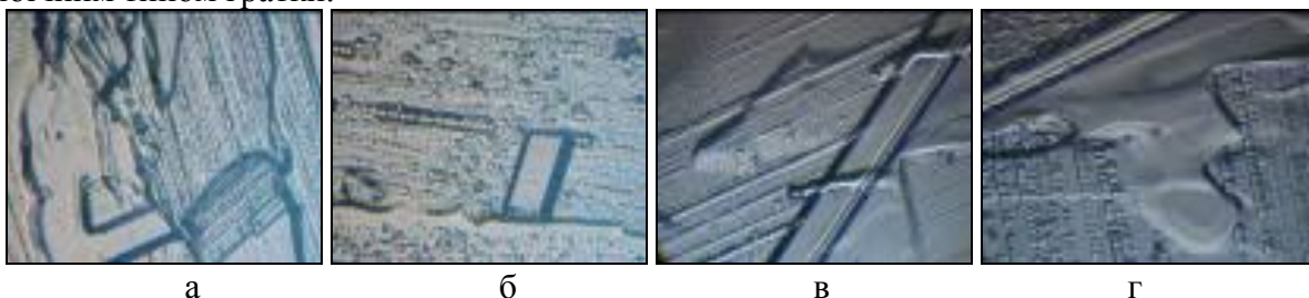
Рисунок 1 – Мікроструктура легованих сплавів Si-Ge-B (а, б) та Si-Ge-As (в, г) після термічної обробки
