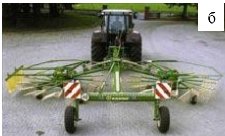
Рис. 2. Розташування роторів граблів-валкоутворювачів Swadro 1401 при бічному (а) та фронтальному (б) укладанні валків
