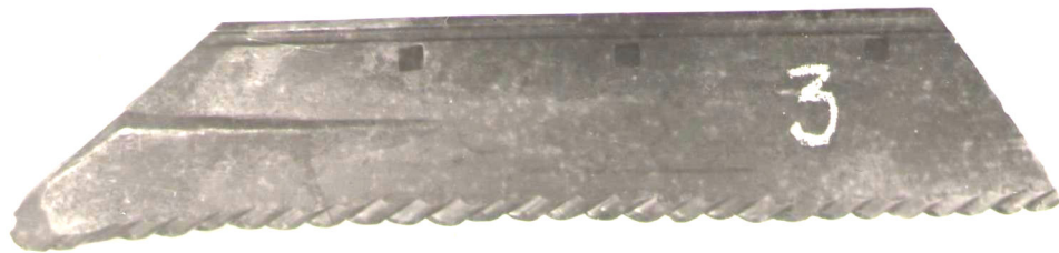
Рисунок 4. Леміш плуга після наробітку 49,0 га
