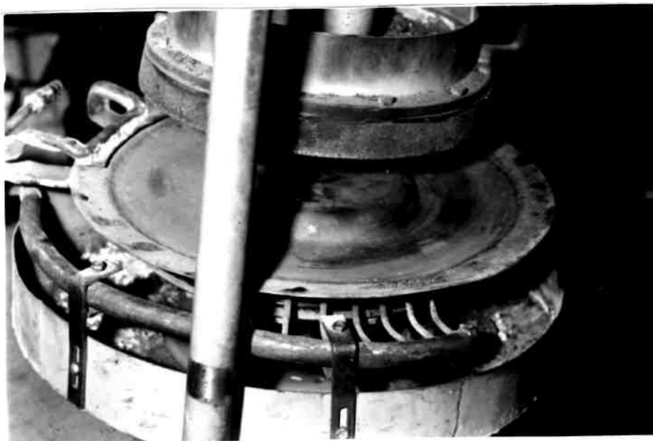
Рисунок 4 - Пристрій для наплавлення цільноштампованого суцільного ножа за допомогою сегментного індуктора
