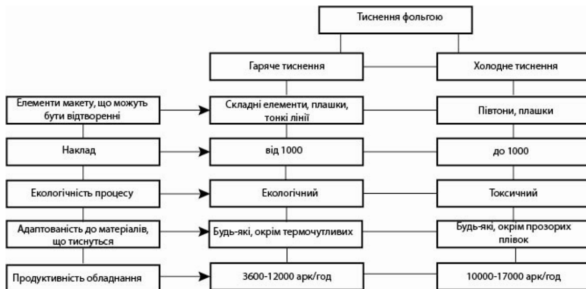
Порівняльна характеристика технологій тиснення фольгою гарячим та холодним способом
